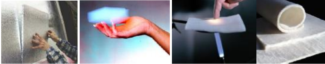
Bild 0-10 Von links nach rechts: verbesserte Isolierung mittels Aerogel-basierten Materialien; Aerogel: ausgeschiedene Nanoporen in einer SiO 2 -Matrix 38 ; flexible nanoporöse Isolierdecken von Insulcon B.V. (2x)
